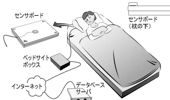
図4. 挿せば忘れて良い隠形全自動睡眠モニタリングシステム概念図（陳ら論文より）
